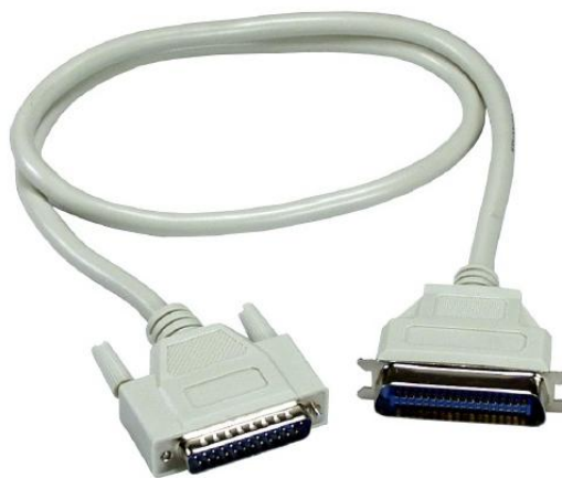
Kabel do podłączenia drukarki - z jednej strony wtyk męski LPT, a z drugiej wtyk Centronics
