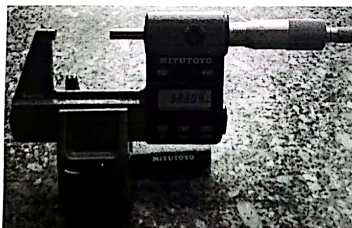
Rys. 3.51. Narzędzie wykorzystane do pomiaru – mikrometr cyfrowy (rozdzielczość 0,001, niepewność pomiaru 0,002, zakres pomiarowy 25÷50 mm)
